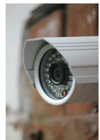
Die Outdoor-Überwachungskameras müssen Schnee, Regen und Feuchtigkeit trotzen, das Gehäuse muss die empfindliche Elektronik schützen. Ist nämlich einmal Feuchtigkeit in der Kamera, verdirbt einem im besten Fall nur eine beschlagene Linse den Spaß an der Videoüberwachung.
